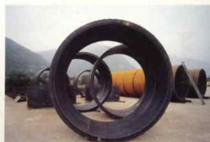
Les modules cylindriques sont constitués de deux fines plaques métalliques de 4 mm d'épaisseur enroulées le long de l'intrados et de l'extrados des anneaux
