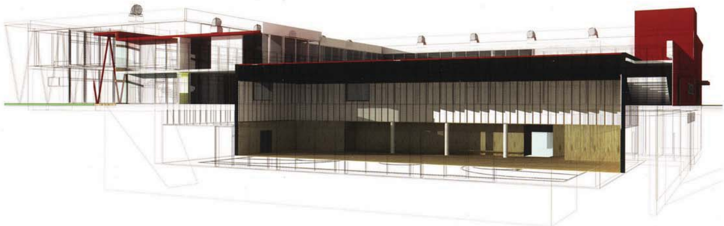
Spaccato per lo studio della palestra incassata nel terreno View of the gymnasium
